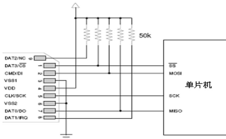
MSP430 有两个 USART 端口，分别为 P3.1-P3.3 以及 P5.1-P5.3。课设中选用 P3.1-P3.3 端口来连接 SD 卡。其中 P3.1 为 SIMO 端，用来与 SD 卡在 SPI 模式下的 MOSI 端相连。P3.2 为 SOMI 端，用来与 SD 卡在 SPI 模式下的 MISO 端相连。而 P3.3 为 UCLK 端，用来与 SD 卡在 SPI 模式下的 SCK 端相连。使用 P3.0 为片选信号，并直接使用开发板上的 3.3V 电源向 SD 卡供电。
