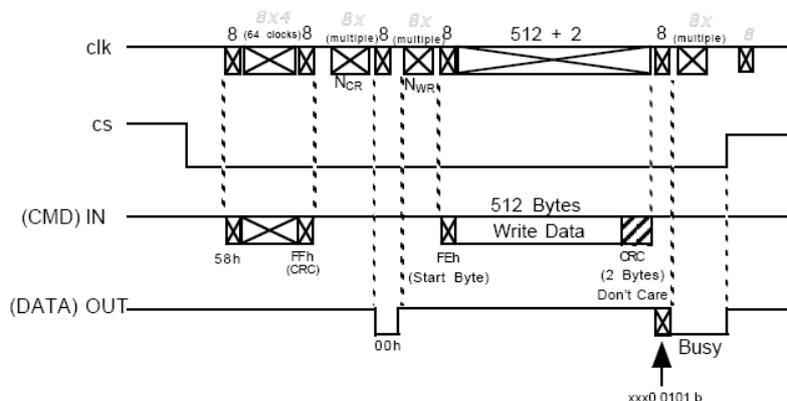
在项目中，写 SD 卡的函数为 `SD_write_sector(unsigned long addr,unsigned char *Buffer)`。输入参数为 SD 卡的物理扇区号以及写入 SD 卡指定扇区中的内容的数组的首地址。
