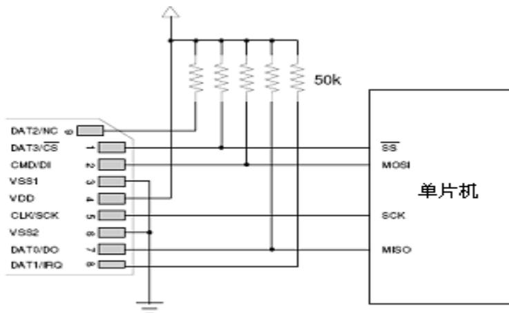
SD 卡支持两种总线方式：SD 方式与 SPI 方式。其中 SD 方式采用 6 线制，使用 CLK、CMD、DAT0~DAT3 进行数据通信。而 SPI 方式采用 4 线制，使用 CS、CLK、DataIn、DataOut 进
