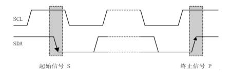
起始和终止信号都是由主机发出的,在起始信号产生后,总线就处于被占用的状态;在终止信号产生后,总线就处于空闲状态。
