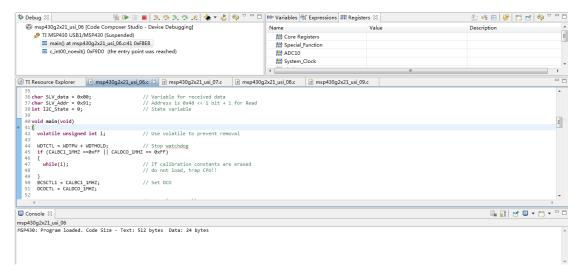
5、现在程序处于单步运行状态,按 F5, F6 可以让程序向下运行,并且可以设置断点,让程序直接运行到断点处。
