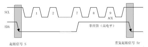
引导过程由起始信号、起始字节、应答位、重复起始信号(Sr)组成。
